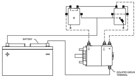
**SOLENOIDS TO MOTOR CONNECTIONS**
