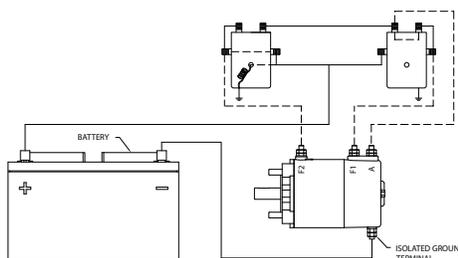
**SOLENOIDS TO MOTOR CONNECTIONS**
